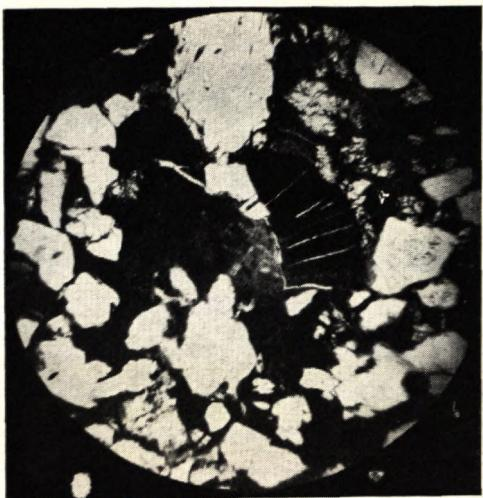
Obr. 1. Glaukonitizace biotitu. U některých zrn je zachována ještě původní struktura. Pískovec z bazální části spodního miocénu. Zvětšeno 22,5 ×.
